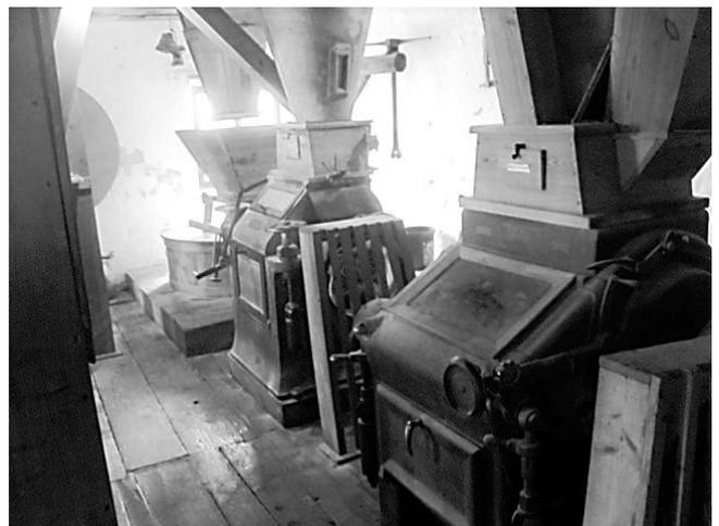
eine leistungsstärkere Turbine ersetzt wurde, der Antrieb für die Mühlen per Lederriemen und Transmission funktioniert immer noch wie vor Jahrhunderten. Vom komplexen Mahlvorgang und
